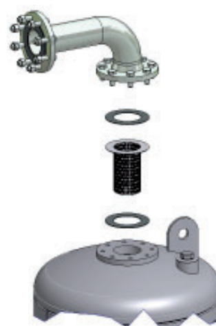
Smontaggio del filtro a cestello
